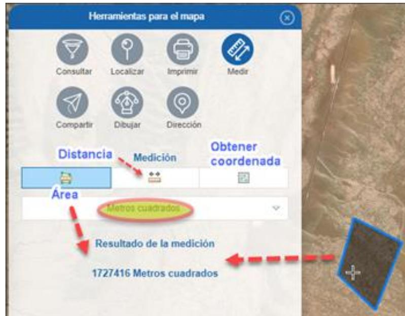
Fig. 20: Ejemplo de medición de área.
